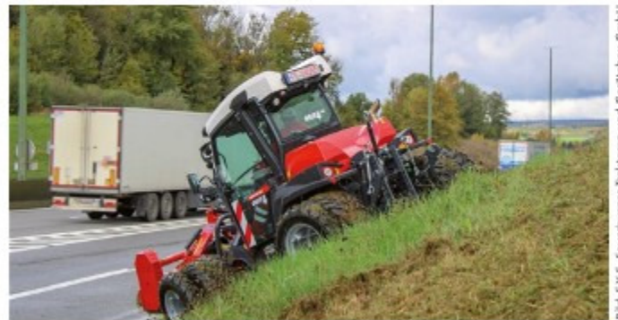
Der Geräteträger eignet sich für Arbeiten am Straßenbegleitgrün oder auf engen Parkplätzen.
