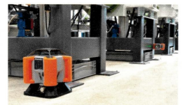
Fertigungsanlage mithilfe eines Universal-lasers in 30 Minuten ausrichten. Seite 20
